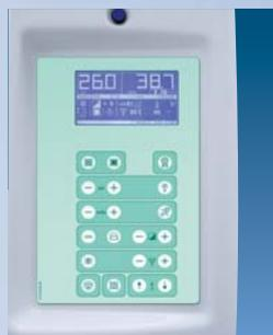
L' **interfaccia utente principale**, al lato della macchina, permette la selezione delle modalità di esame in pochi secondi. Il display grafico LCD mostra, oltre ai parametri completi del sistema, la Dose Ghiandolare Media (AGD).
