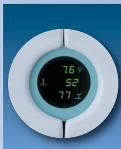
L' **interfaccia utente ausiliaria** mostra rapidamente l'angolo di rotazione del braccio, la forza di compressione applicata e lo spessore della stessa. Nell'unità digitale, questa è posta vicino al detettore ed integra una tastiera per i codici ACR.
